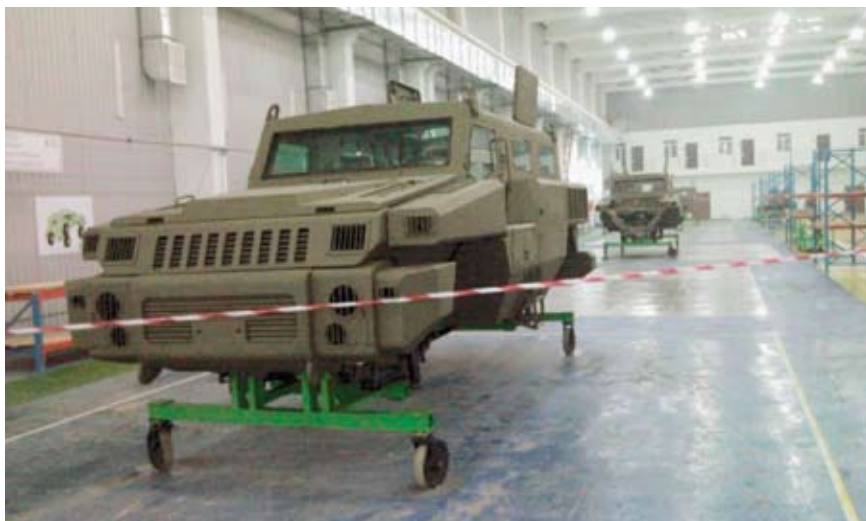
CI-DESSUS Acheminement de coques de blindés résistant aux mines sur la chaîne de production de MODIAR, en Azerbaïdjan.
